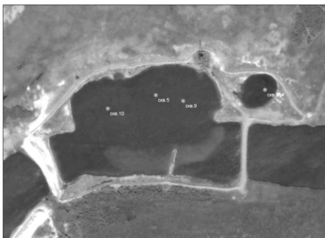
Рис. 2. Изолированный дамбами участок протоки Малый Гусинец и положение устьев скважин в «большом и малом грифонах».
