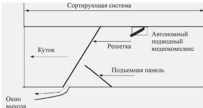
Рис. 3. Схема расположения подводного видеокомплекса на сортирующей системе.
