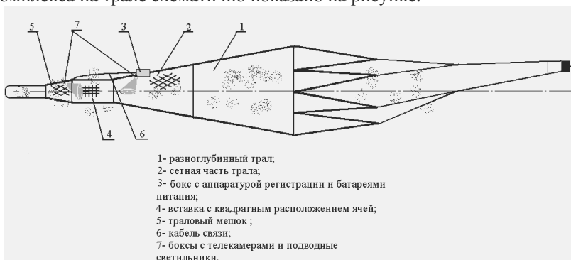
Рис. Схема установки телекомплекса на разноглубинном трале
