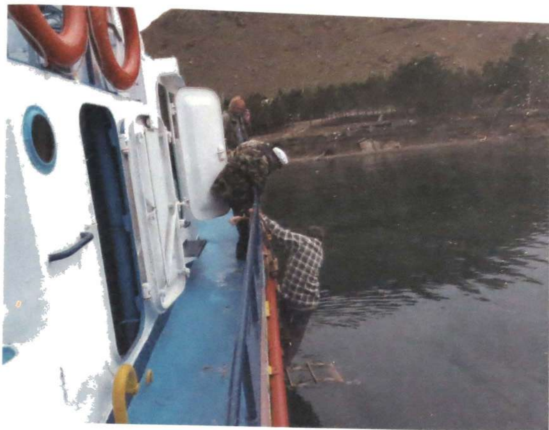
Установка датчика эхолота на судно
